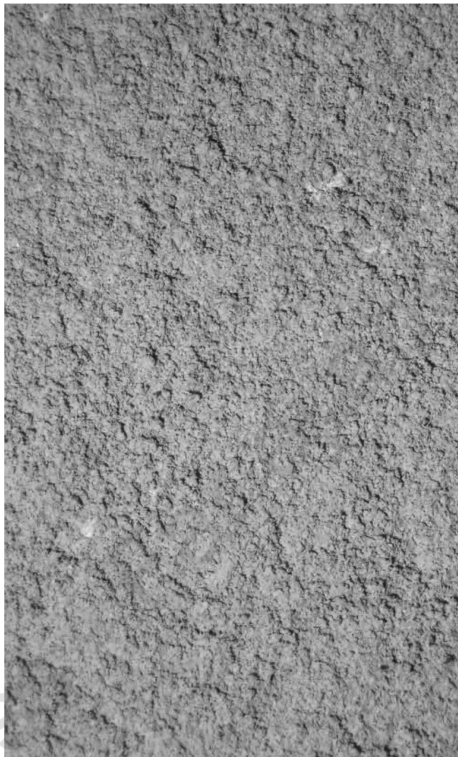
PUTSSTRUKTUR 6. OORGANISK YTPUTS, VÄFFLAD YTA, KORNMAX 2 MM.
