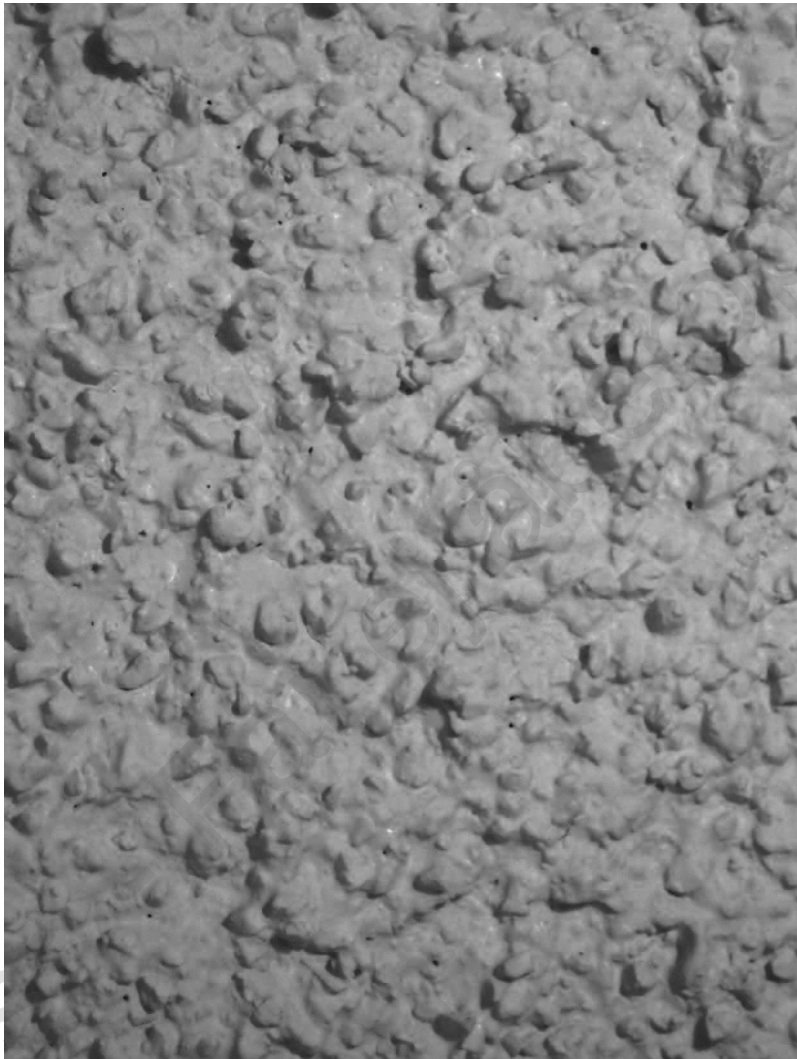
PUTSSTRUKTUR 11. ORGANISK YTPUTS, SPRITPUTS FIN, KORNNAX 5 MM.
