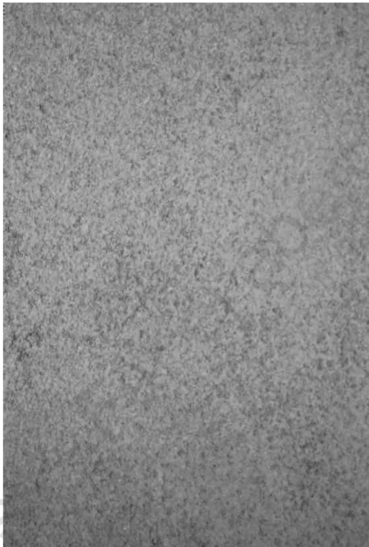
PUTSSTRUKTUR 2. OORGANISK YTPUTS, SLÄTPUTSAD FILTAD, KORNMAX 0,5–1 MM.
