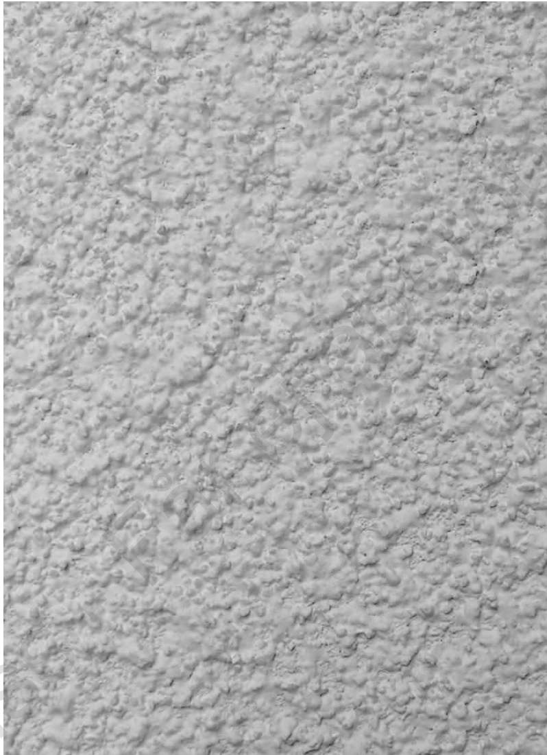
PUTSSTRUKTUR 13. ORGANISK SPRUTAD YTPUTS, KORNMÅX 1,5 MM.
