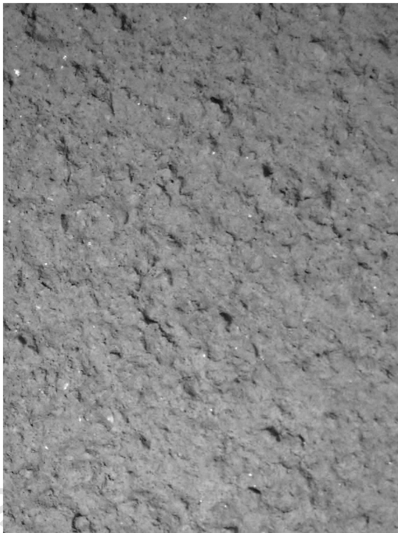
PUTSSTRUKTUR 8. OORGANISK YTPUTS, RIVPUTS GROV, KORNNMAX 3 MM.
