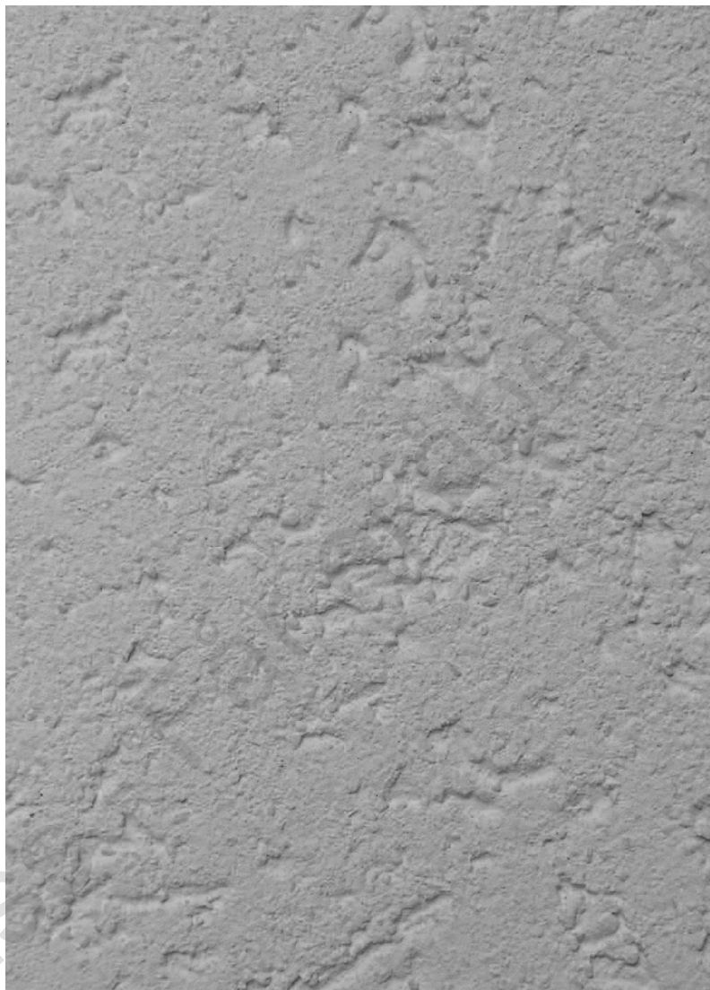
PUTSSTRUKTUR 16. ORGANISK RILLEN YTPUTS, KORNNAX 1,5 MM.
